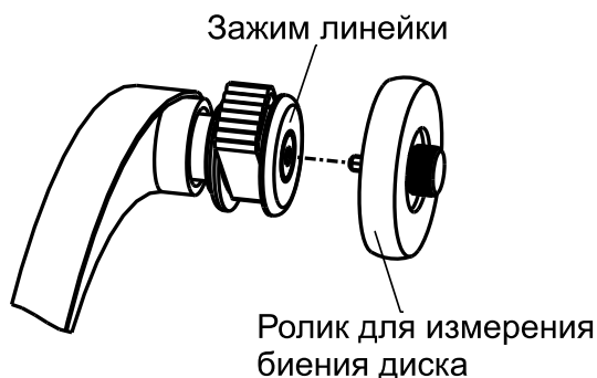
Рисунок 7.5 – Ролик для измерения биений
