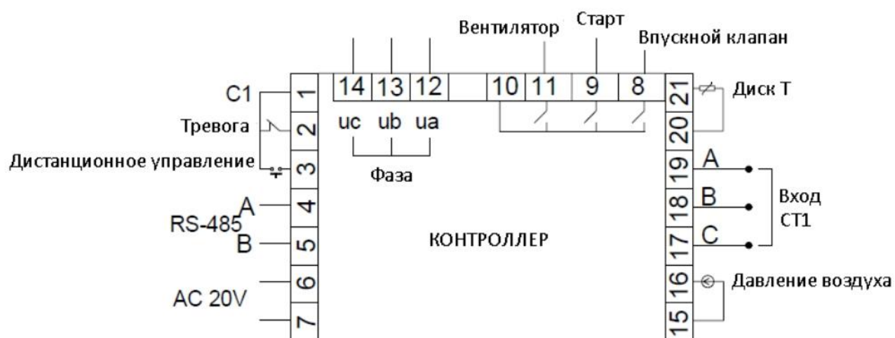
Рисунок 4.2.1 Схема расположения клемм
