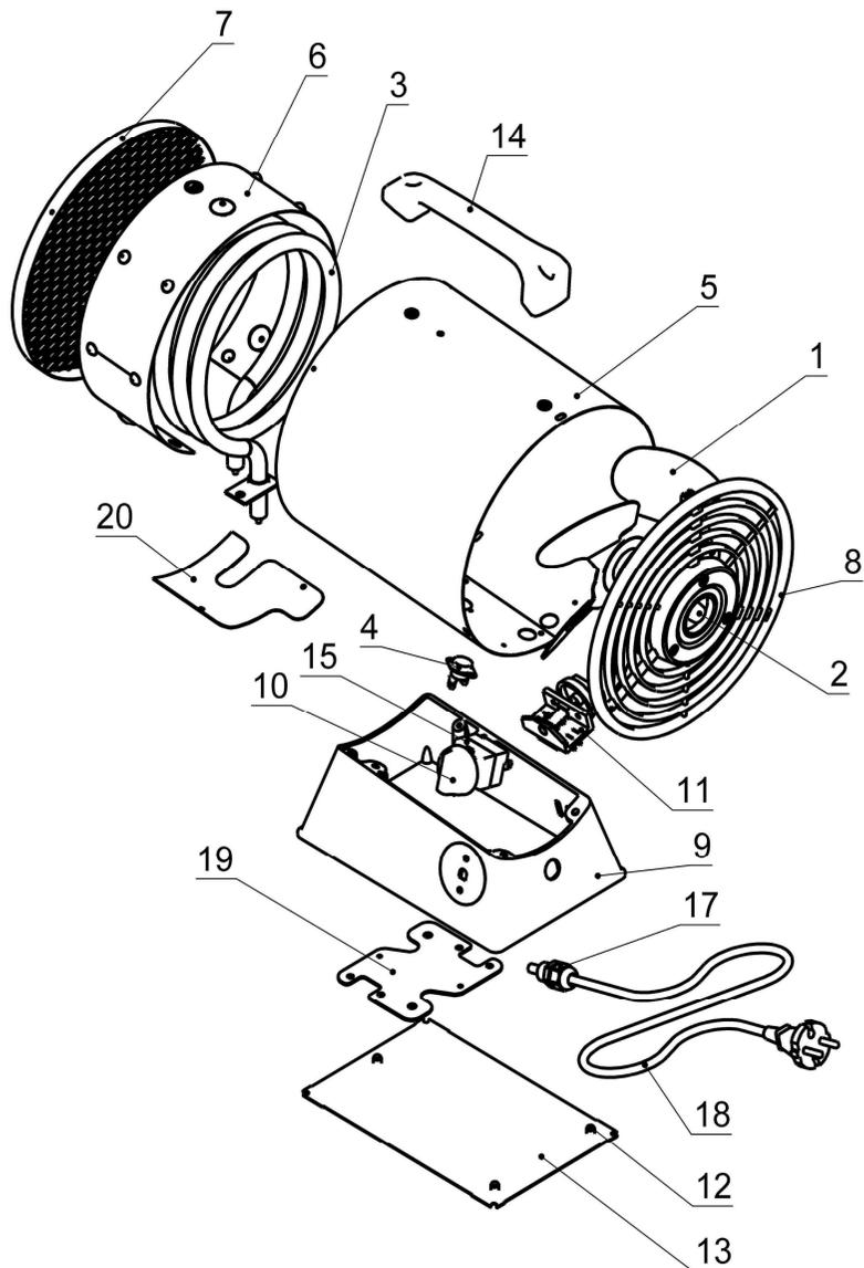
Конструктивно тепловентилятор представляет металлический корпус, в котором размещены электродвигатель с крыльчаткой и электронагревательный элемент (далее ТЭН).
