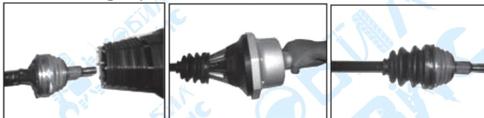
Затем нажмите на кнопку ослабления захвата снизу приспособления, чтобы снять пыльник ШРУСа с приспособления. Смотрите рисунок
