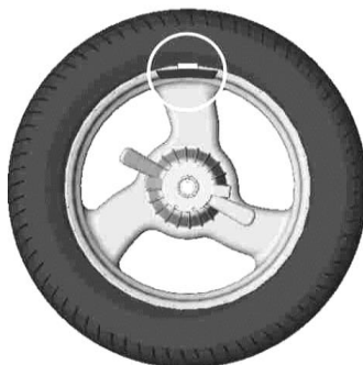
Рисунок 6.24 – Груз установлен в положение «12 часов»
