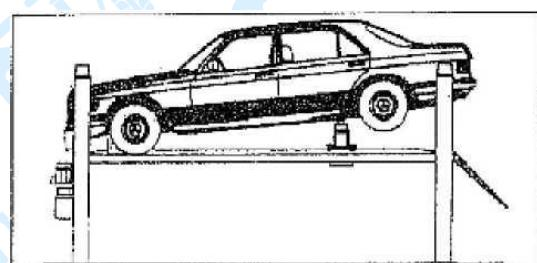
Поднимайте автомобиль, находясь при этом только в безопасной рабочей зоне, обозначенной в инструкции к 4- стоечному подъемнику.
