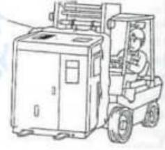
При проверке внешнего вида убедитесь, что отсутствуют повреждения, порывы шлангов, деформация корпуса, отсутствие или брак запасных частей и т. д.
