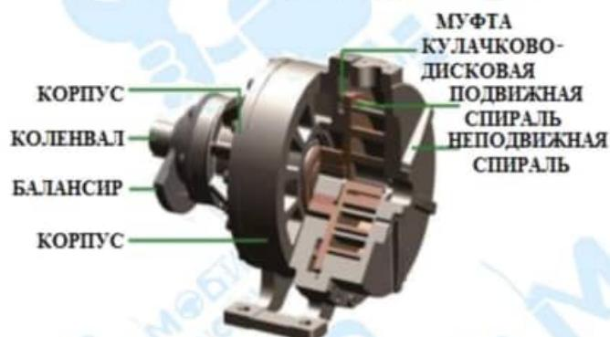
Устройство спирального компрессорного узла
