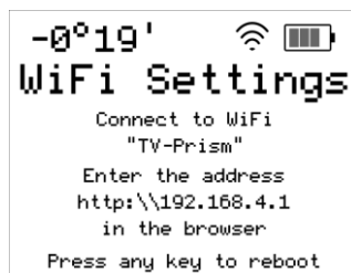
Рисунок 4.4 – Экран инклинометра в режиме точки доступа Wi-Fi
