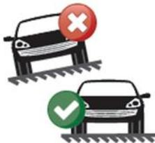
Используйте домкрат исключительно на ровной и твердой поверхности.
