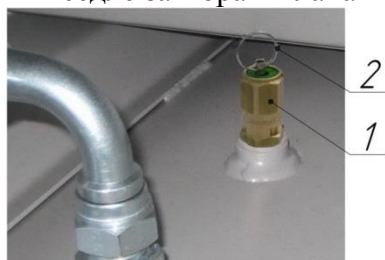
Рисунок 9 – Клапан предохранительный пружинного типа
