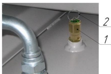
Рисунок 8 – Клапан предохранительный пружинного типа
