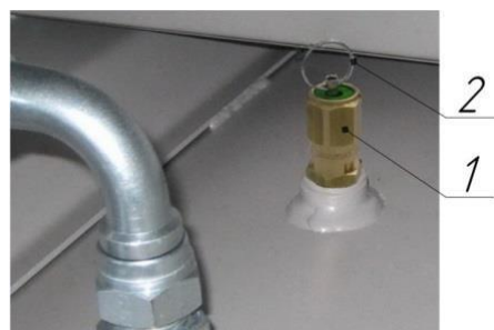
Рисунок 11 – Клапан предохранительный пружинного типа
